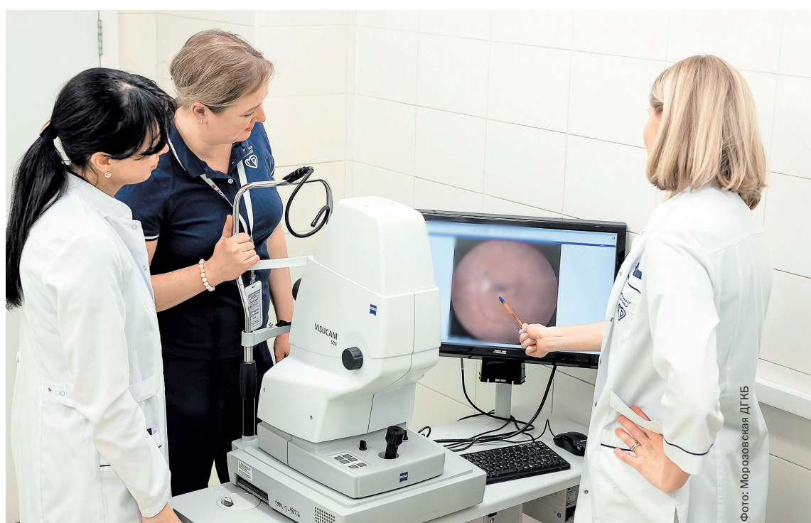
▲ Фундус-камера применяется в офтальмологии для ранней диагностики заболеваний, скрининга и контроля за лечением
