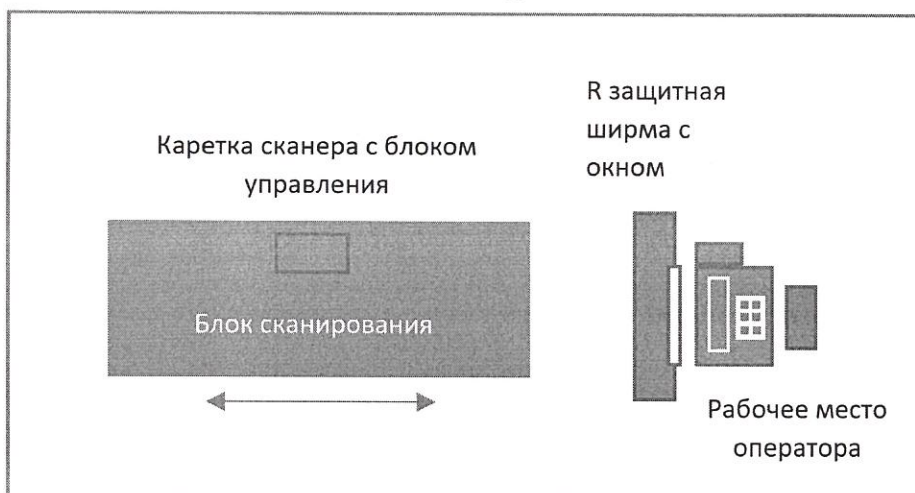
Рисунок 1 – Схематичное изображение кабинета для проведения исследования двухэнергетической рентгеновской абсорбциометрии: а – вид сбоку, б – вид сверху: рабочее место оператора и денситометр
