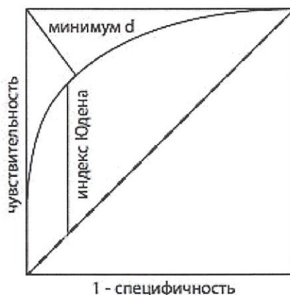
Рисунок 2 – Методика определения оптимальных значений порога активации («cut-off»)
