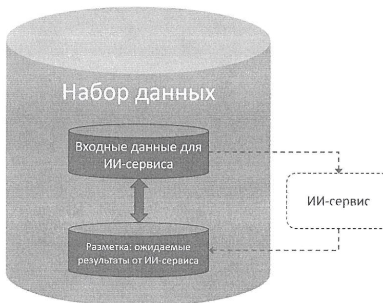
Рисунок 2 – Единица набора данных (в наборе данных присутствуют парные, однозначно соответствующие друг другу записи входных данных и разметки)
